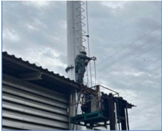
รูปที่ 2-1 การติดตามตรวจสอบ คุณภาพอากาศจากปล่อง Hot Oil Boiler
